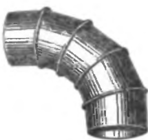
Рис. 5. Фасонные части на металлических воздуховодах (внешний вид и графическое изображение с примерными размерами)
